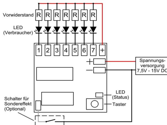
Die LEDs an den Ausgängen können je nach Wunsch auch in Reihen-oder Parallelschaltung angeschlossen werden.
